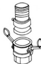
RP = Verbindungsstück mit Nockensperre (Polypropylen oder rostfreier Stahl AISI 304 und 316L)
